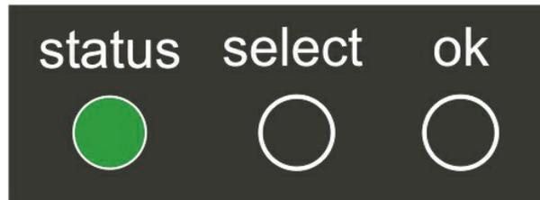
Den aktuellen Schaltzustand des jeweiligen Power Ports erkennen Sie an der Farbe mit der die entsprechende LED leuchtet (rot=ausgeschaltet/grün=eingeschaltet).
