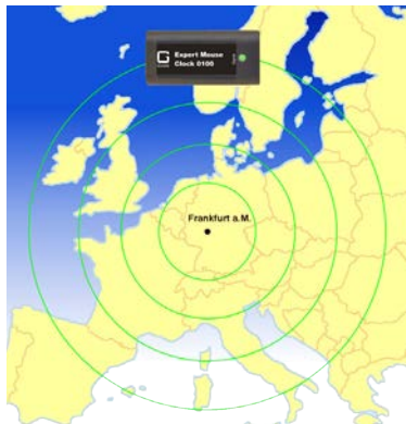
Abb. 2: Ausbreitung des DCF77-Signals
